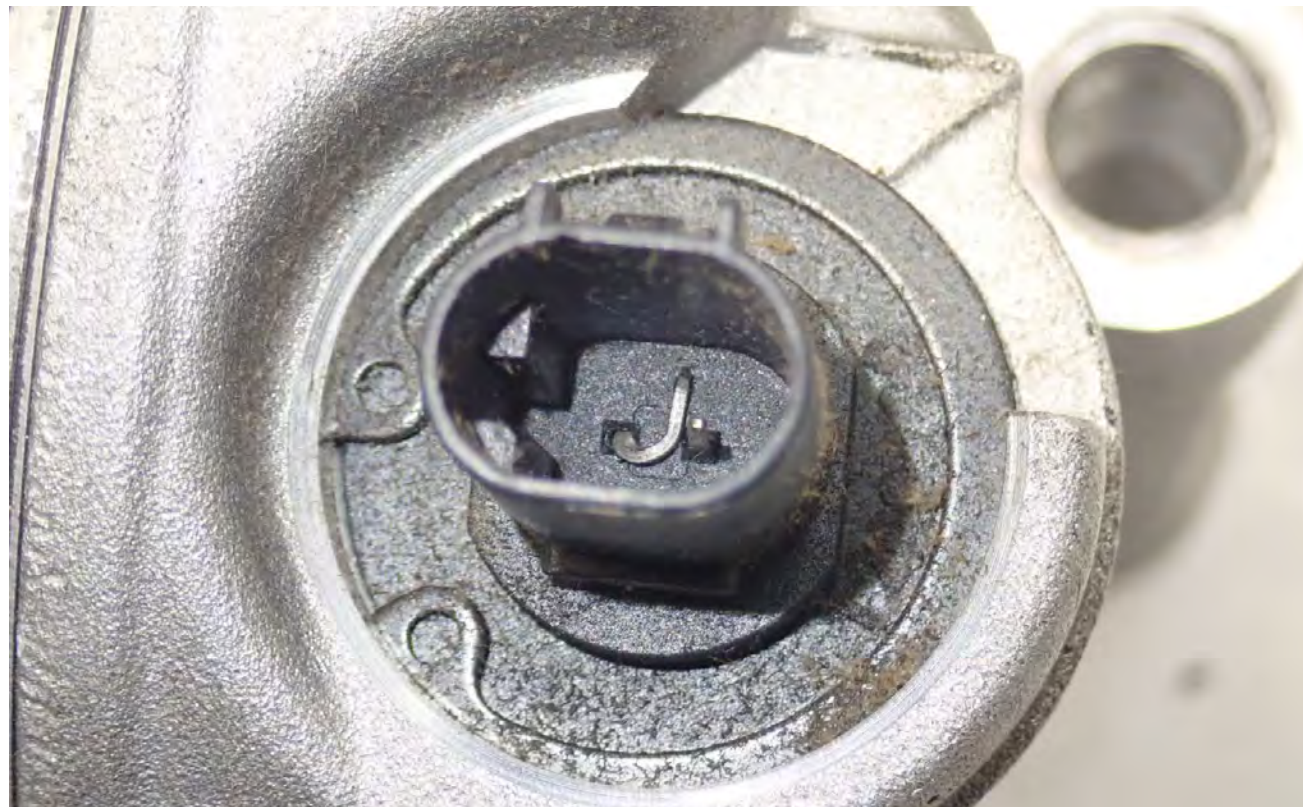
Fig. 1: Bent pin
